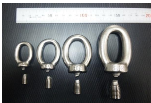
M8～M16＝首下ニゲ部で破断(SUS304)
